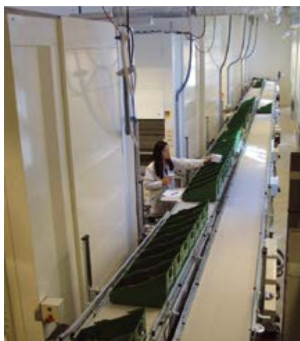
Системы Tornado установлены в линию, а сотрудники отбирают препараты и укладывают их в коробки, которые транспортируются конвейером. Системы хранения занимают пространство в высоту до самой крыши.
